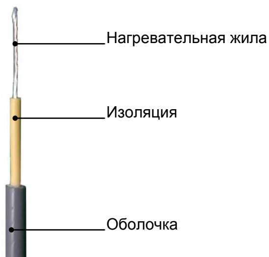
Рис. 1 Одножильный кабель с одним слоем изоляции и оболочкой
