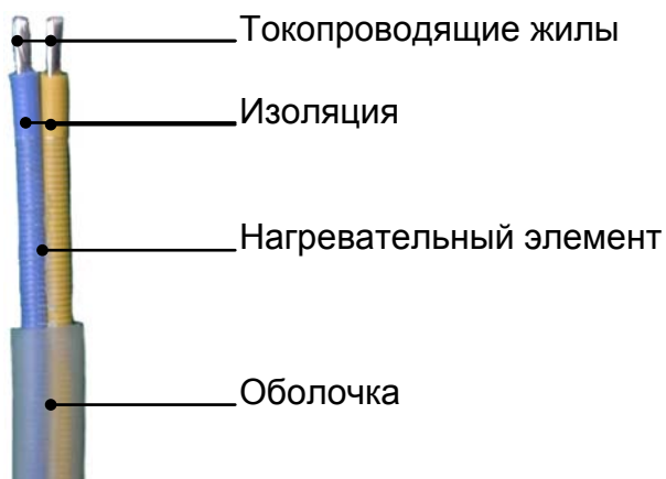
Рис. 5 Резистивный параллельный нагревательный кабель (зональный)
